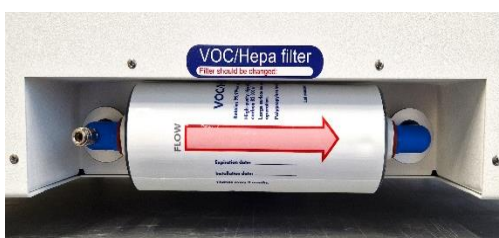
Εικόνα 12.3 Σωστά τοποθετημένο φίλτρο VOC/HEPA
