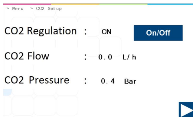
Εικόνα 13.25 Υπομενού ρύθμισης CO 2 επωαστήρων εξωσωματικής γονιμοποίησης πολλαπλών θαλάμων MIRI® TL6 και MIRI® TL12
