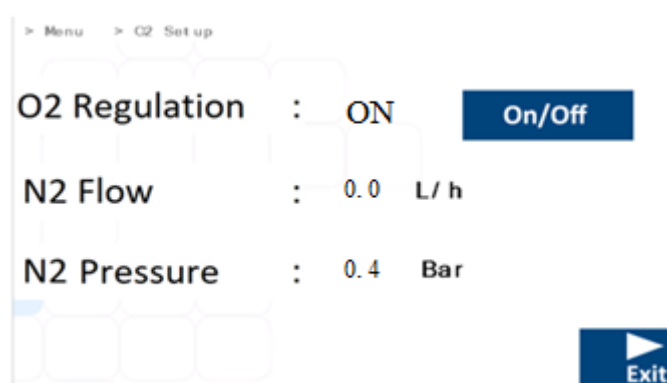
Εικόνα 16.4 Υπομενού ρύθμισης O 2 επωαστήρων εξωσωματικής γονιμοποίησης πολλαπλών θαλάμων MIRI® TL6 και MIRI® TL12
